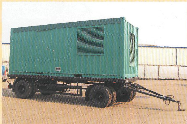
>>> Передвижная дизельная электростанция ЗАО «ГрандМоторс»
